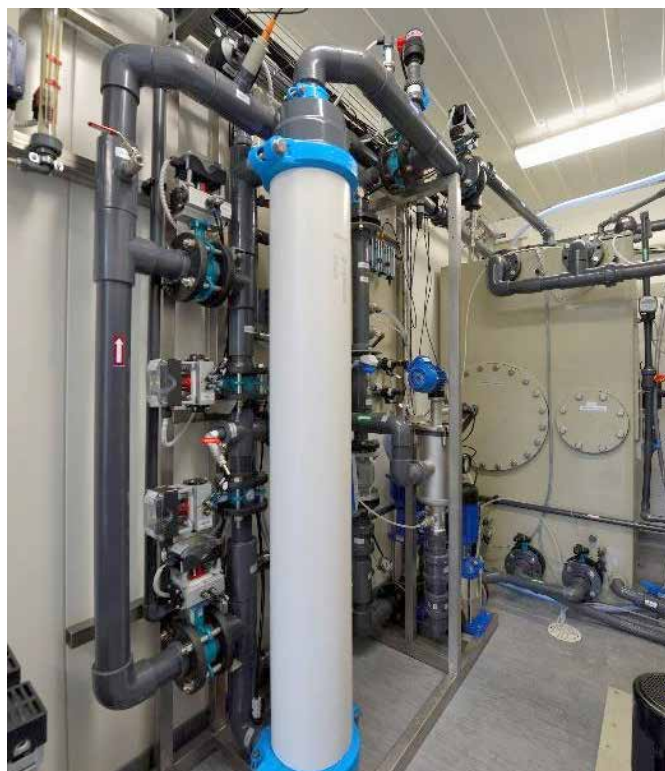
Pilotna ultrafiltracijska naprava z enim UF-modulom membrane. (foto: Ludvik Mekuč)
