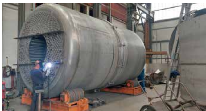
Varjenje cevi na čelno steno novega IT 2 v TPK Orometal.
