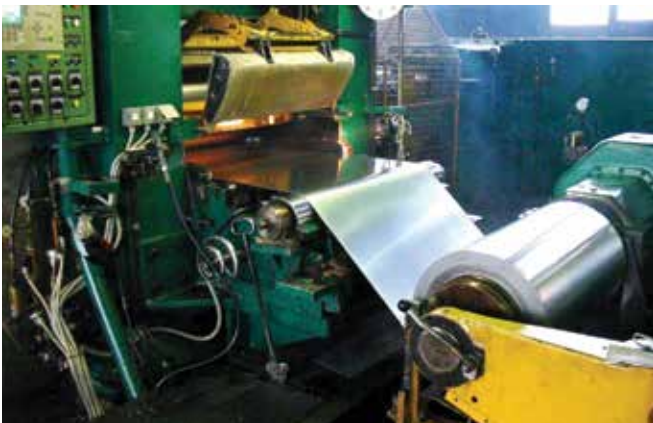
Valjanje Titancinkove pločevine na valjalni progi Schmitz
