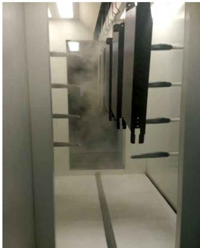
Nanašanje praškastega laka v avtomatski lakirni kabini
