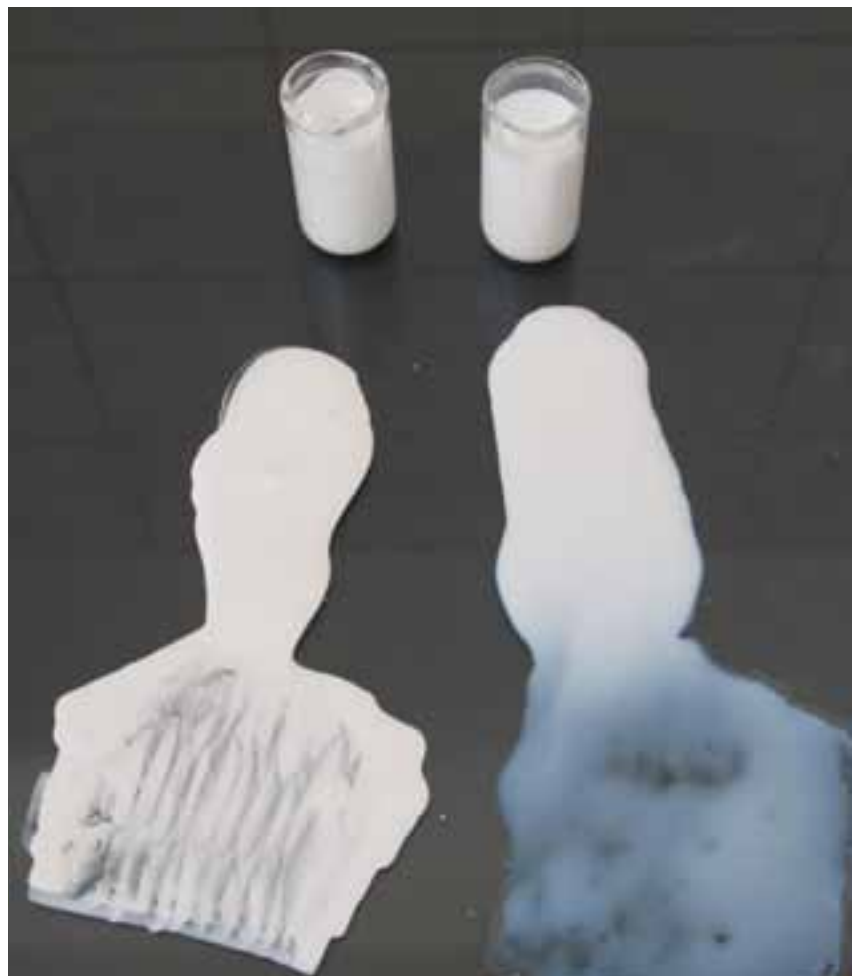
Razlika med pigmentnim (beli) in UF TiO 2 (moder podton)
