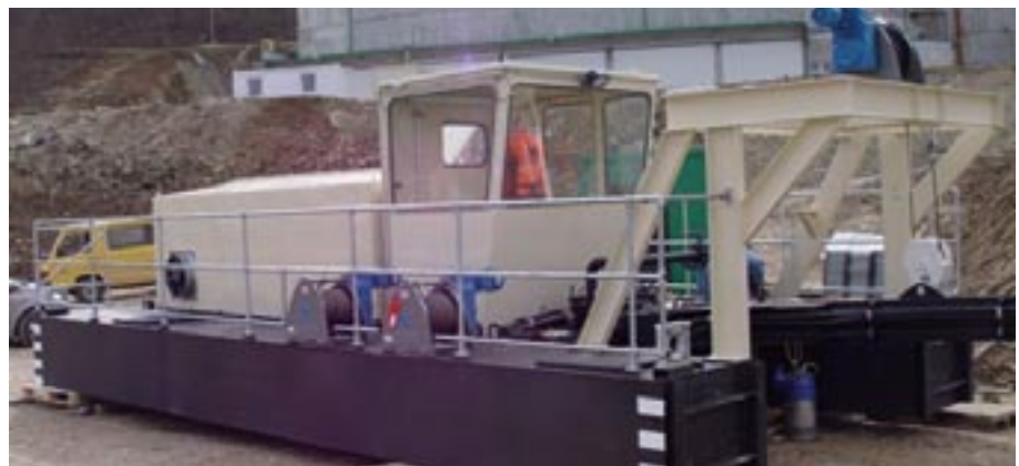
Montaža črpalnega bagra na suhem
