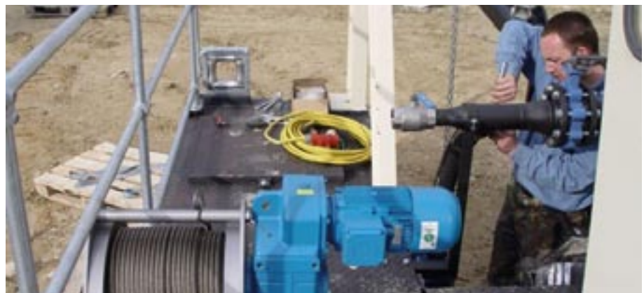
Na vitel navita pletenica bo omogočala sidranje in pomik bagra
