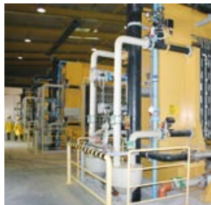
Štiri filter stiskalnici v obratu za filtriranje sadre
