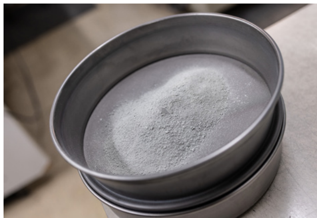
Odpadni filter prah, preekstrudiran, zdrobljen v čipse in ponovno zmlet, dodajamo masi enake kvalitete izdelka.
