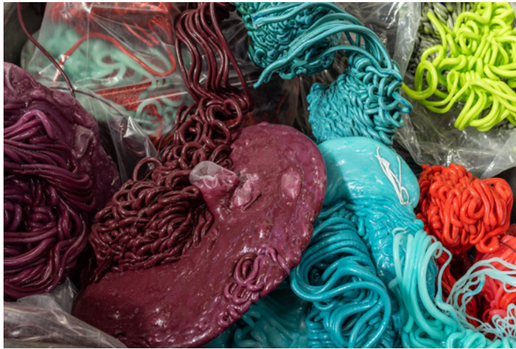
Pri proizvodnji masterbatchev tehnološki izmet čistih materialov vračamo v celoti. Zbiramo ga po niansah, izdelamo granulato in ga vračamo kot vhodni material pri proizvodnji izdelkov.
